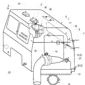
Bauteile des Saugergehäuses 2.6 G
