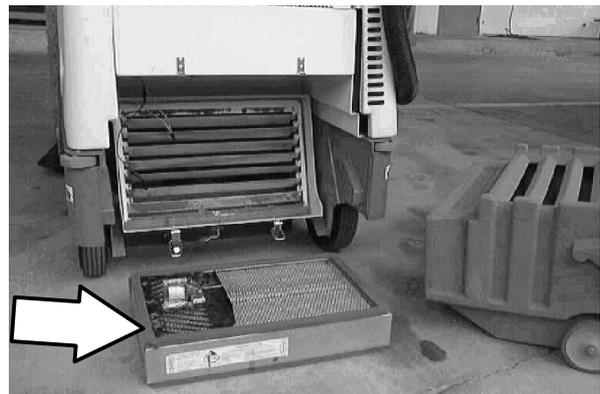
7. Heben Sie den VCS™ System Schüttelfilter aus dem Filter.
