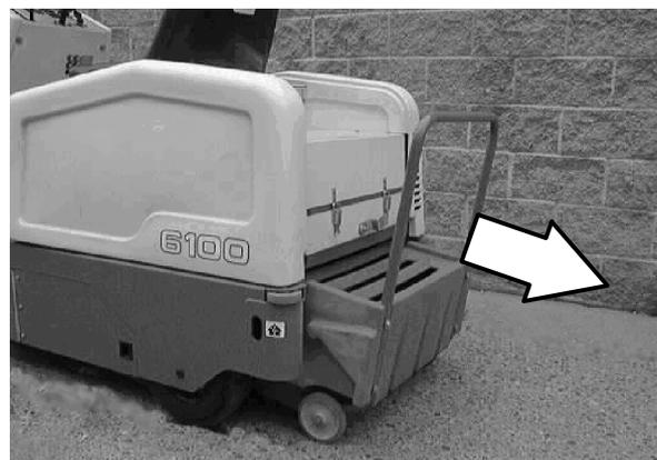
7. Entleeren Sie den Behälter. Entleeren Sie den Behälter.
