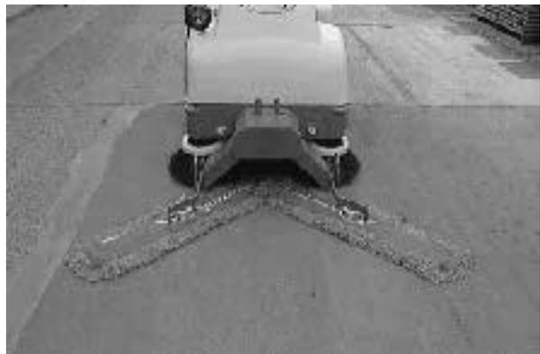
8. Um die QuickMop™ -Schutzabdeckung zu entfernen, lösen Sie die Schnappschalter. Die Schutzabdeckung sollte in regelmäßigen Intervallen entfernt werden, um Wartungsarbeiten vorzunehmen.
