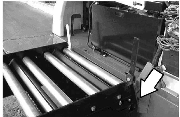
12. Greifen Sie die Batteriegehäuseschlitz, und ziehen Sie das Batteriegehäuse auf den Batteriewagen.
