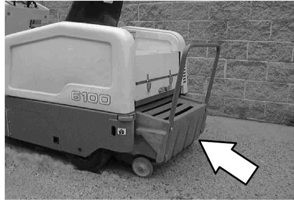
Der Behälter wird mit einer Halterung in betriebsbereiter Position gehalten.
