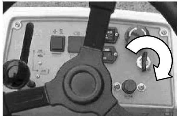
3. Lösen Sie die Feststellbremse.
