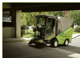
Kompakte Kabine mit 1,98 Metern Höhe sichert eine Zufahrt bei niedrigen Einfahrtshöhen, während der Allradantrieb die Bordsteinklimmungsleistung optimiert
