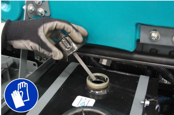
An der Oberseite des Behälters befindet sich ein Einfüllverschluss. Dieser besitzt ein eingebautes Entlüftungsventil und einen Meßstab für den Flüssigkeitsstand. Diese Kappe ist alle 800 Betriebsstunden auszuwechseln.
