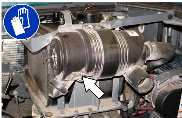
Nehmen Sie das Filterelement heraus. Mit einem feuchten Tuch werden der Endverschluss und die Gehäuse-Innenseite sorgfältig ausgewischt. Reinigen Sie auch die Dichtungsflächen des Gehäuses.
