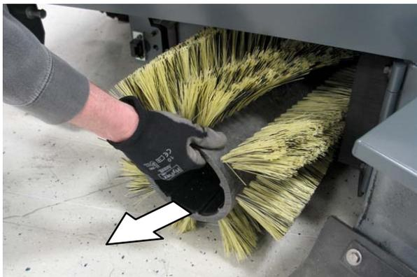
5. Drehen Sie die Hauptbürste um oder ersetzen Sie die Bürste.
