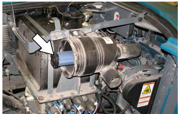
Bringen Sie das Filterelement im Luftfiltergehäuse an und bringen Sie dann die Staubkappe mit dem Wasserablass nach unten zeigend wieder an.
