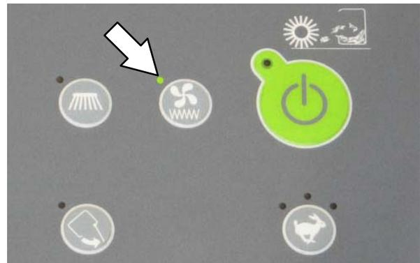
*HINWEIS: Schalten Sie den Saugventilator aus, wenn Sie große nasse Bereiche oder Pfützen kehren. Dadurch wird verhindert, dass der Staubfilter beim Kehren nass wird.*
