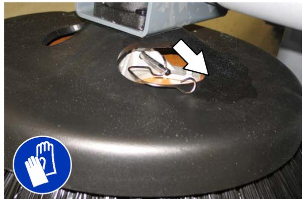
*HINWEIS:* Wenn sich keine Antriebsnabe auf der neuen Bürste befindet, nehmen Sie die Antriebsnabe von der alten Bürste ab und setzen Sie sie auf die neue Bürste auf.
