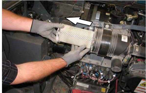
Tauschen Sie das Sicherheitsfilterelement aus, falls der Primärfilter dreimal ausgetauscht wurde. Auch eine Auswechslung des Sicherheitsfilterelements darf erst vorgenommen werden, wenn ein verminderter Lufteinlass festgestellt wird.
