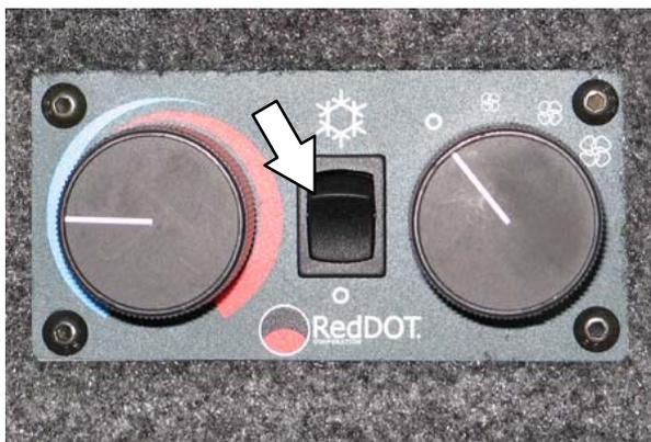
Mit dem *Temperaturschalter* können Sie die Kabinentemperatur regulieren. Mit dem *Ventilatorschalter* können Sie die Temperatur der Klimaanlage regulieren.
