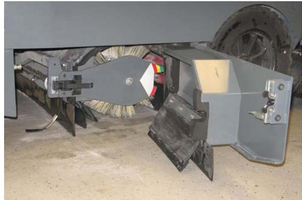
3. Entriegeln Sie die Bürstenvorplatte, und nehmen Sie sie aus der Maschine.
