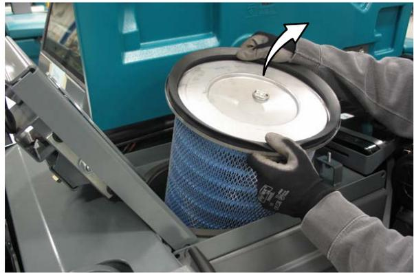
4. Reinigen bzw. entsorgen Sie das Staubfilterelement. Siehe *REINIGEN DES STAUBFILTERS*.
