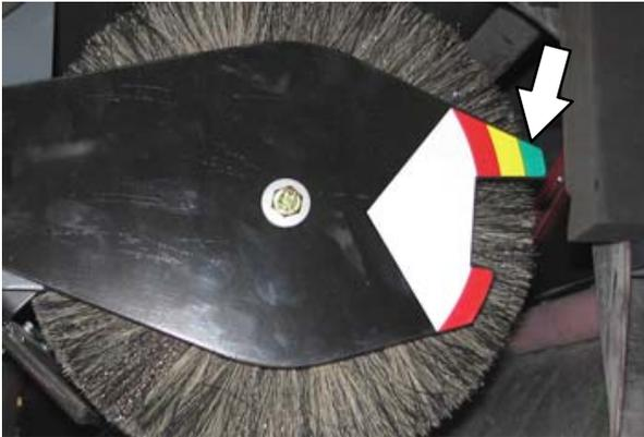
2. Lösen Sie den Einstellknopf für die Hauptbürste und verschieben Sie den Zeiger, bis er mit dem Farbband auf der Bürstenvorplatte übereinstimmt. Drehen Sie den Einstellknopf wieder fest.
