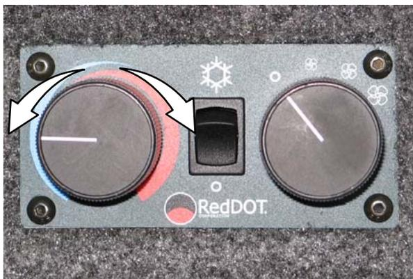
Mit dem *Ventilatorschalter* können Sie die Geschwindigkeit des Ventilators regulieren. Dieser Knopf wirkt sich auf Heizung und Klimaanlage aus.
