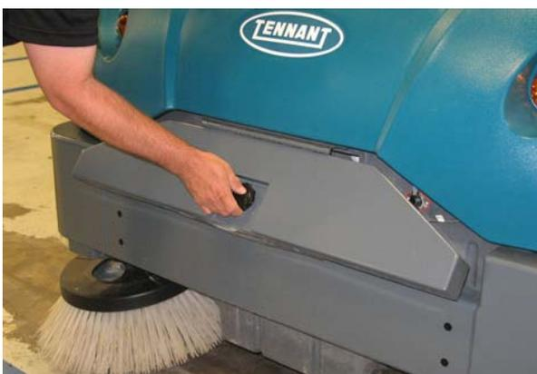
Ziehen Sie am Griff der Schmutzbehälter-Wartungsklappe, um die Klappe zu öffnen. (SN 006501 – )
