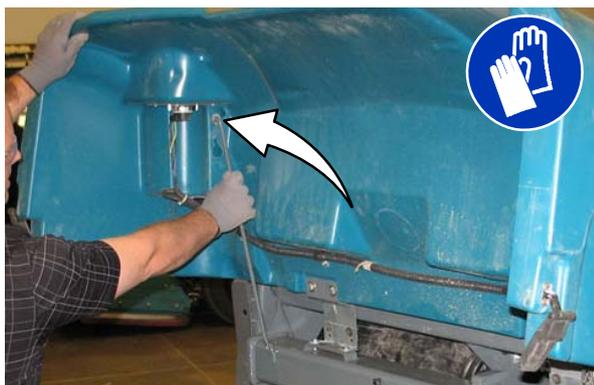
2. Entfernen Sie die Staubfilterhaube.
