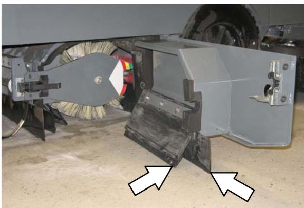
*HINWEIS:* Die Bürstenklappen-Schürzen sind mit Schlitzöffnungen versehen, mit denen der richtige Abstand von der Bodenfläche eingestellt werden kann. Diese Einstellung muss bei geschlossenen Klappen vorgenommen werden.
