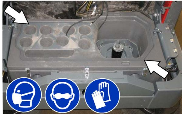
Öffnen Sie die Zugangsklappe der Zyklonabdeckung, um Staub und Verschmutzungen aus der Zyklonabdeckung zu entfernen.
