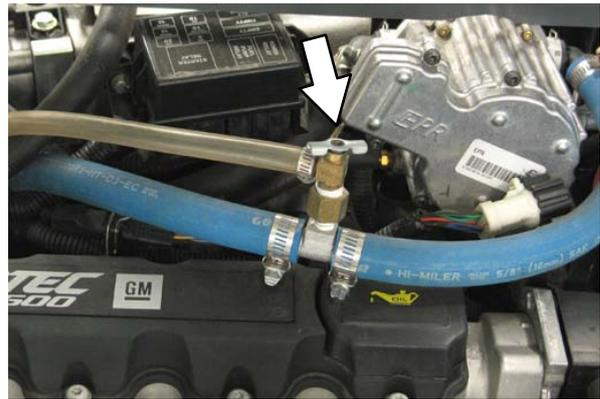
Platzierung des Ablasshahns bei Benzin-Maschinen mit Seriennummer 002003 und niedriger.
