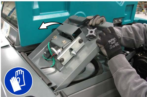
3. Nehmen Sie den Staubfilter aus dem Filtergehäuse.
