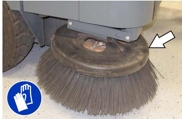
**S30:** Drehen Sie den **Einstellknopf für die Seitenbürsten** gegen den Uhrzeigersinn, um den Umfang des Bürstenabdrucks zu vergrößern, und im Uhrzeigersinn, um den Umfang des Bürstenabdrucks zu verkleinern.
