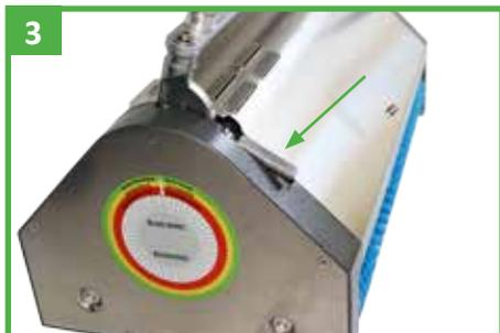
**EN STARTING THE MACHINE (SWITCH ON/OFF)**
