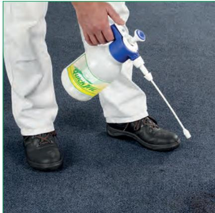
**Stark verschmutzte Flächen** (z. B. Laufstraßen) mit QUICK TRIC vorsprühen. Hierzu wird das Produkt 1:6 mit Wasser verdünnt (1 Teil QUICK TRIC auf 6 Teile Wasser) und mit dem DR.SCHNELL Drucksprüher auf die verschmutzten Flächen aufgesprüht. Die befeuchteten Flächen mit dem RAPIDOMAT PRO bearbeiten. Bei Teppichen, die den normalen Verschmutzungsgrad aufweisen, ist Vorsprühen nicht notwendig.
