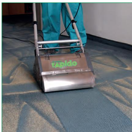
**Spritzschutz durch Renovatoren** (Pulverauffangschalen) **ersetzen**. RAPIDO Teppichreinigungspulver durch erneutes Abfahren aufnehmen. Nicht erreichtes Pulver mit Staubsauger entfernen. Verschmutztes Pulver als Hausmüll entsorgen.
