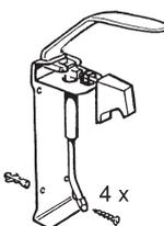
Befestigung: in geeigneter Höhe mit den beiliegenden vier Schrauben und Dübeln befestigen.
