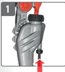
**Schlauch an Pumpebel schrauben**
