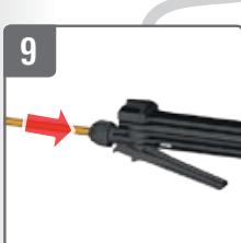
**Sprührohr an Handventil stecken und festziehen**
