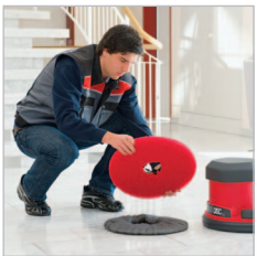
Pad und Stahlwollering werden für das Spraykristallisieren von Marmorböden benötigt.
