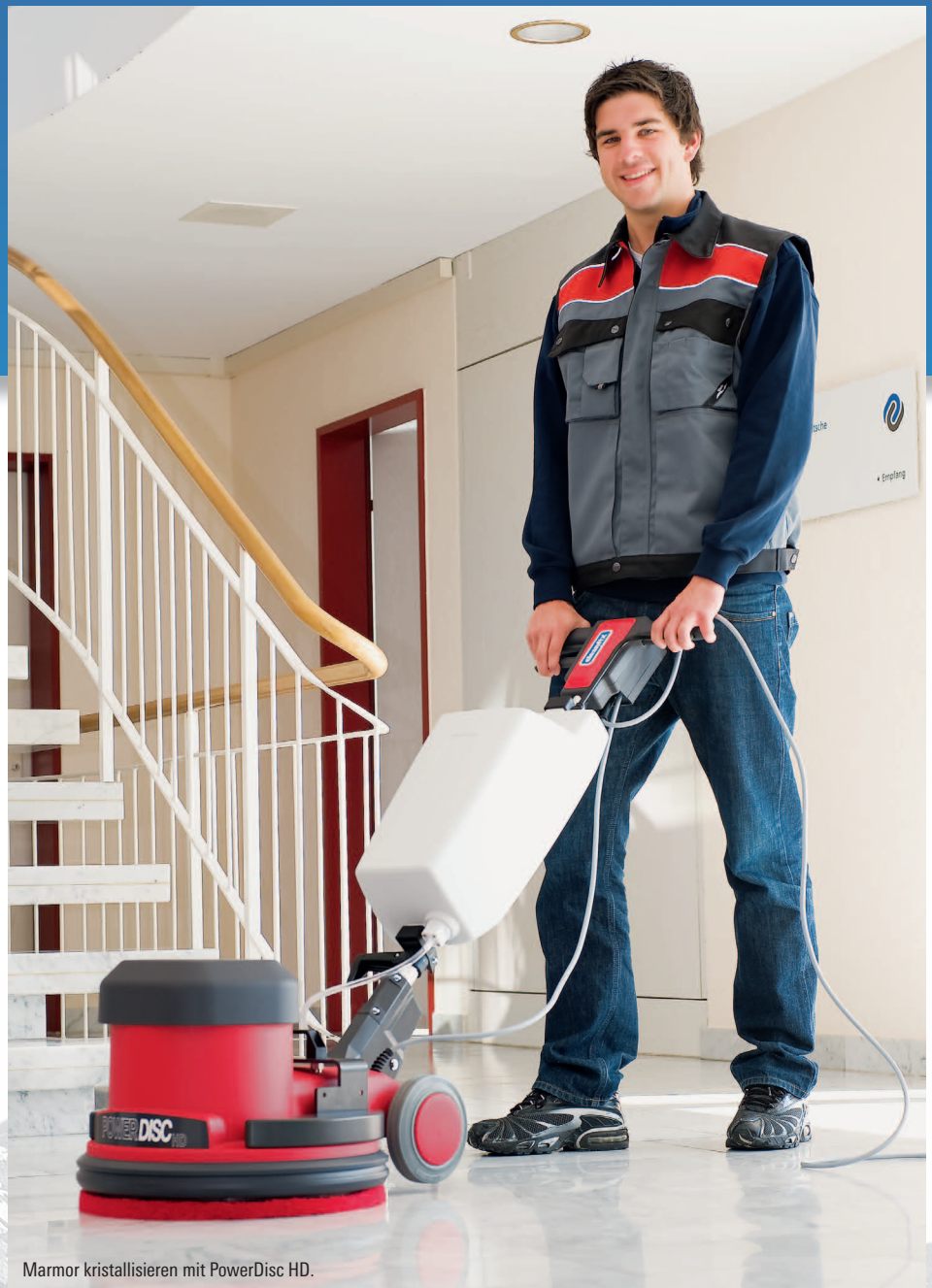
Pad und Stahlwollering werden für das Spraykristallisieren von Marmorböden benötigt.
