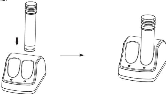
1. Steckern die Batterie in der Nut von der Akkuladegerät
