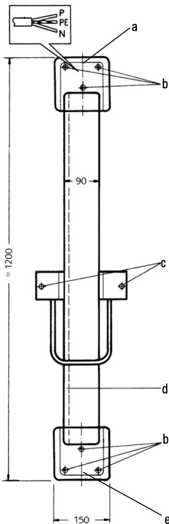
9.1 墙托架 (a, e) 的打孔处(b)作记号。
