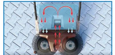
Geringe Staubbildung dank intelligente Luftführung. Innerhalb der Maschine wird die staubhaltige Luft gesäubert und in den Kehrkreislauf zurückgeführt.
