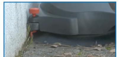
Dank seitlicher Führungsrolle ist randnahes Kehren mühelos möglich ohne die Maschine oder Flächen zu beschädigen.
