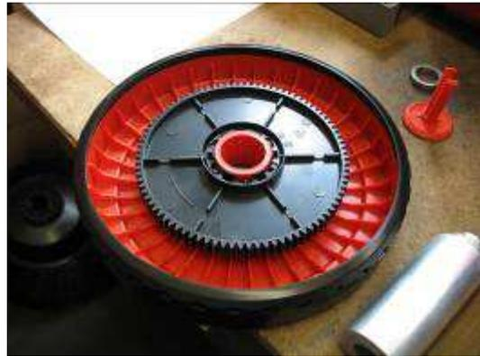
Nun müssen Sie die Schrauben der Walzenaufnahmen lösen (Im Ritzel), danach können Sie die Walzenaufnahmen herausziehen.
