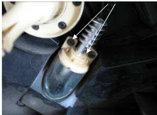
Neue Motoren einsetzen und mit den 4 Schrauben fixieren. Einstellschablone auf den Lagerzapfen schieben. Die Schablone gibt den Abstand der Antriebsschnecke vor. Wenn die Schnecke satt an der Schablone anliegt, Befestigungs-Schrauben der Motoren anziehen.
