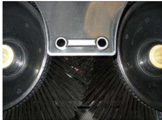
Zum Einbau der neuen Kehrlippe muss diese mit einem Haar-Föhn oder durch eintauchen in warmes Wasser erwärmt werden. Das Erwärmen macht den Kunststoff geschmeidiger und erleichtert das Verriegeln. Stecken Sie die Kehrlippe auf die Kehrplatte. Die Befestigungs-Nippel müssen jetzt durch die beiden Öffnungen geschoben und verriegelt werden.
