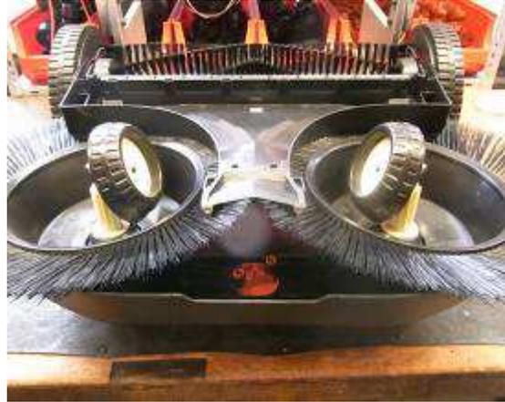
Die Schrägräder sind im Lagerzapfen-Deckel verrastet und können von Hand abgezogen werden. Je nach Verschmutzungsgrad der Maschine muss hier mehr Kraft aufgewendet werden.
