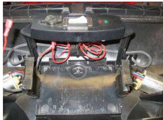
Neuen Akku einsetzen und in umgekehrter Reihenfolge wieder zusammenbauen. Unbedingt auf richtige Polarität beim Anschließen der Batteriekabel achten.
