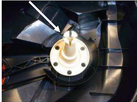
Jetzt können Sie die Zahnhülse und die Kupplung mit einer Drehbewegung aus dem Tellerbesen ziehen.
