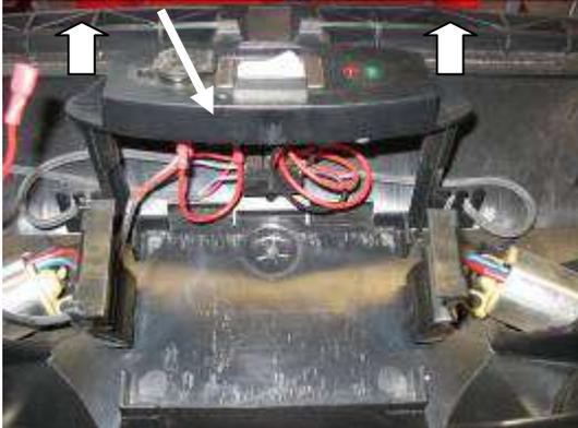
Ladebuchse Schalter LED-Überwachung
