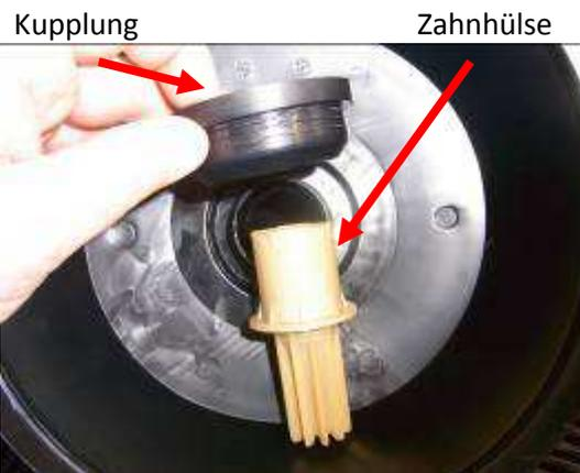
In dem Kupplungsgehäuse befindet sich der Kupplungsmitnehmer. Bitte beim Zusammenbau darauf achten, dass die Mitnehmerzapfen in die ovalen Aussparungen des Kupplungsgehäuses eingesteckt werden. Alle Teile werden wieder in umgekehrter Reihenfolge zusammengebaut.
