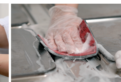
Die Oberfläche mit der grauen Seite von AbraClean 4000 reinigen. Wenn die Oberfläche extrem verschmutzt ist, verwenden Sie die graue Seite von AbraClean 1000.
