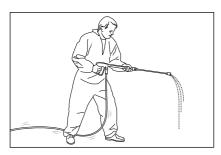
Aus der Lanze kommt ein unregelmäßiger Strahl. Der Hochdruckschlauch vibriert.
