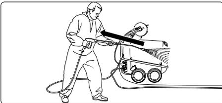
Achten Sie darauf, daß beim Reinigen mit dem Hochdruckstrahl an der Lanze ein deutlich spürbarer Rückstoß entsteht. (siehe techn. Daten S. 4)
