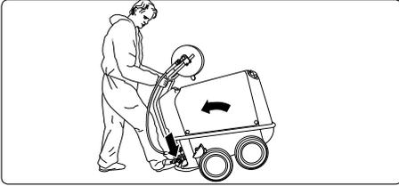
8. Maschine lenken: Zur Richtungsänderung das Gerät durch Druck gegen die Fußstütze und gleichzeitiges Ziehen am Fahrbügel ankippen und drehen.
