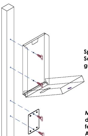
Spender mit 2 selbstschneidenden Schrauben 8 x 19 (mit Spitze) befestigen
