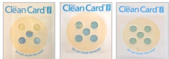
Direkt im Anschluss an die Reinigung eingesetzt, eröffnet sich die Möglichkeit, schnell zu reagieren, und entsprechende Maßnahmen sofort einzuleiten. Der **Zeitpunkt des Tests** ergibt sich entsprechend den spezifischen Betriebsanforderungen und Fragestellungen. Dies kann z.B. nur nach der Reinigung sein, bei evtl. Zwischenreinigungen, um vor einer Desinfektion die Sauberkeit zu überprüfen, oder meist erst nach Abschluß der kompletten Prozedur.
