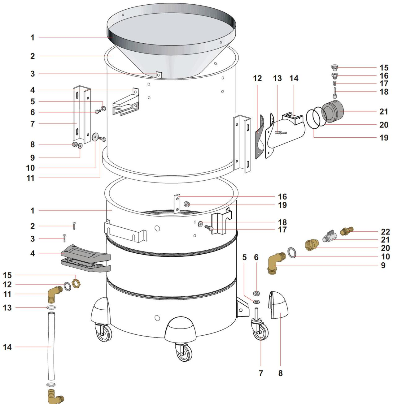
Abb. / Fig. 2: Ersatzteilzeichnung 4 / Spare parts drawing 4
