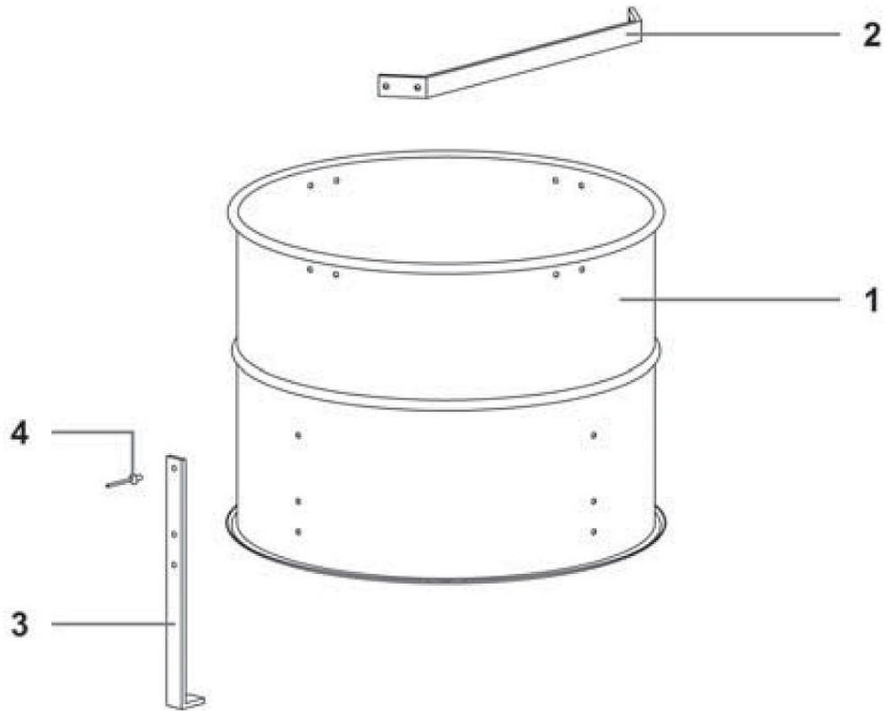
Abb. / Fig. 4: Ersatzteilzeichnung / Spare Parts Drawing 4 für / for flexCAT 378-EOT-PRO
