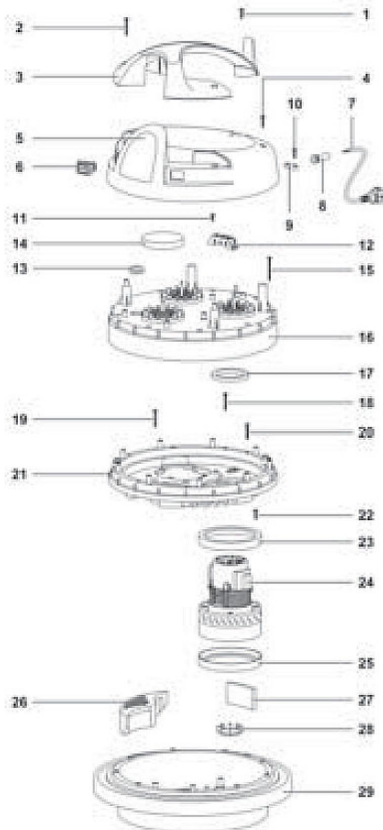
Abb. / Fig. 1: Ersatzteilzeichnung / Spare Parts Drawing 1 für / for flexCAT 378-EOT-PRO
