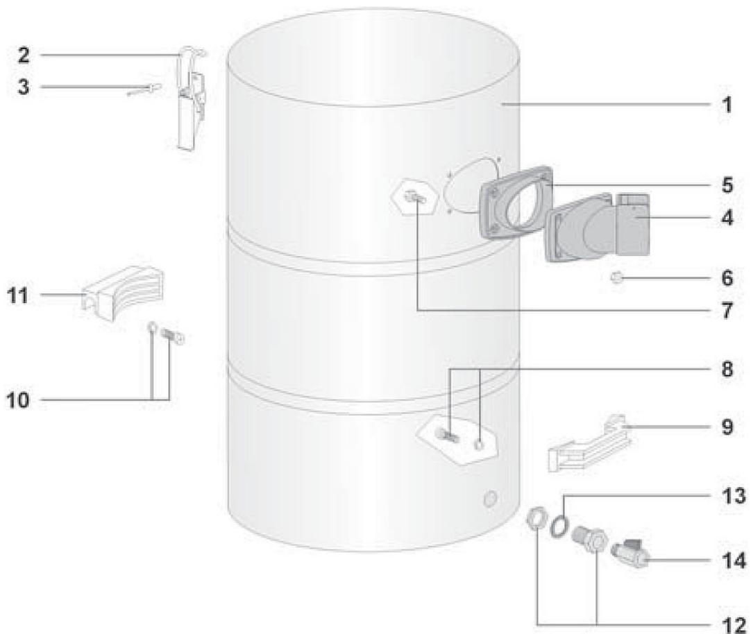
Abb. / Fig. 5: Ersatzteilzeichnung / Spare Parts Drawing 5 für / for flexCAT 378-EOT-PRO
