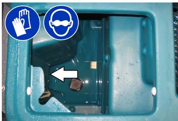
5. Spülen Sie den Schwimmerschalter und den Flachfilter ab. Lassen Sie den Frischwassertank ab.
