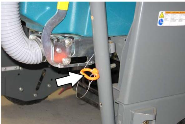
**! WARNUNG:** Der angehobene Schmutzbehälter kann herunterfallen. Sichern Sie ihn mit dem Schmutzbehälter-Stützstift.
