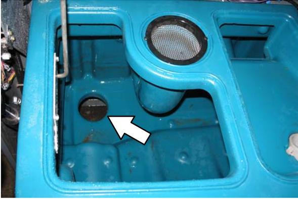
7. Reinigen Sie die Ablassöffnung und bringen Sie die Ablassschraube wieder an. Drücken Sie den Hebel zur Befestigung nach unten. Achten Sie darauf, dass die Ablassschraube richtig sitzt, bevor Sie sie befestigen.
