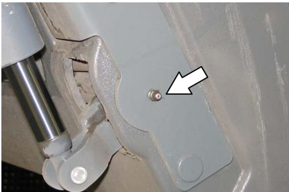
An der anderen Seite der Maschine befinden sich die Schmierstellen der Drehrohre und der Antriebspumpe.
