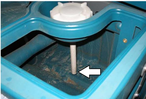
7. ES-Maschinen: Spülen Sie den ES-Filter ab. Entfernen Sie den ES-Filter, falls erforderlich, aus dem Schmutzwassertank.
