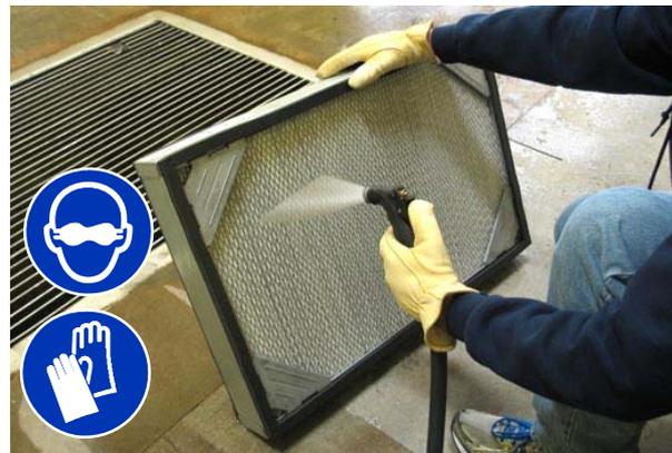
*HINWEIS: Achten Sie darauf, wenn zum Reinigen des Staubfilters Wasser verwendet wird, dass der Filter völlig trocken ist, bevor Sie diesen wieder im Schmutzbehälter anbringen. **Bringen Sie keinen nassen Staubfilter an.***
