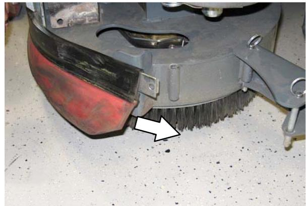
5. Schieben Sie das neue Wischgummi in die Seitenbürsten-Einheit.
