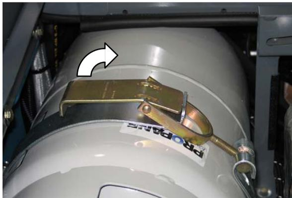
7. Richten Sie die Öffnung im Tankkragen mit dem Zentrierstift aus und legen Sie den vollen Flüssiggastank vorsichtig auf die Wanne. Sichern Sie den Tank mit den Befestigungsbändern.
