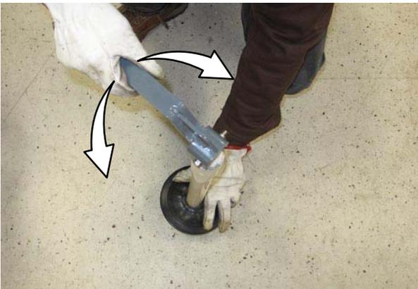
8. Schließen Sie das variable Ablassventil des Schmutzwassertanks.
