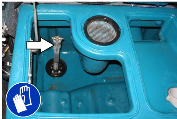
4. Öffnen Sie das variable Ablassventil des Schmutzwassertanks.
