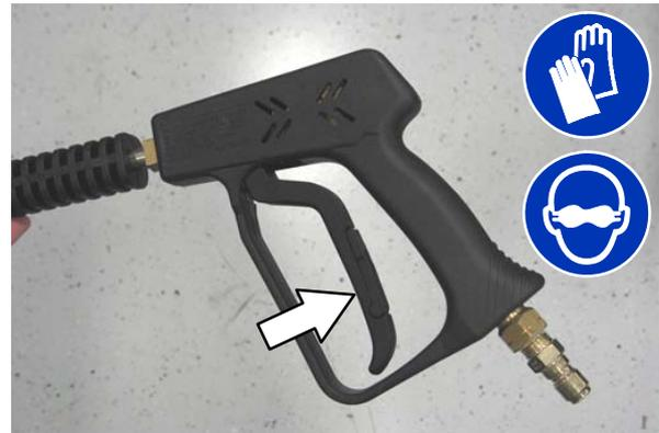
11. Lassen Sie den Hebel los, sobald der Reinigungsvorgang abgeschlossen ist.
