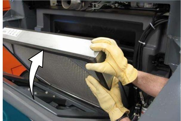
10. Schließen Sie die Filterabdeckung und sichern Sie diese mit den Hebeln am Schmutzbehälter.
