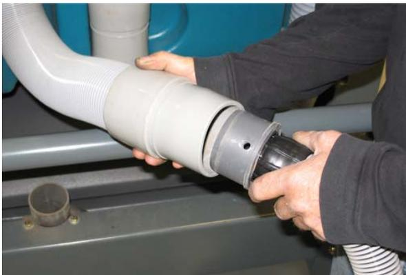
3. Setzen Sie die Düse auf den Stab auf.
