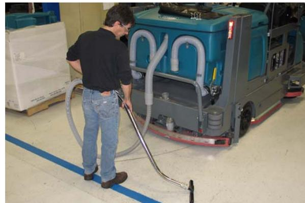
8. Drücken Sie nach dem Saugen den Schrubb-Saugventilator / Wischgummi-Schalter, um die Saugfunktion auszuschalten. Die Lampe über dem Schalter erlischt.
