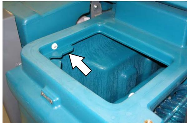
2. Öffnen Sie den Schmutzwassertankdeckel und füllen Sie den Schmutzwassertank mit Wasser (nicht über 60°C), bis der Schmutzwassertank etwa halb voll ist.
