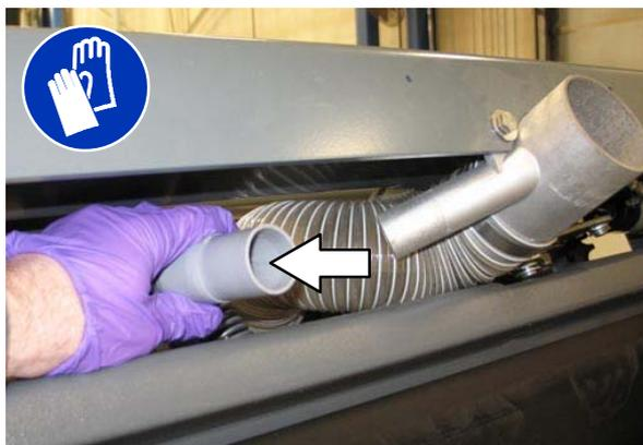
9. Spülen Sie den Schmutz aus dem Schmutzfilter und dem Schmutzbehälter. Entfernen Sie, falls erforderlich, den Schmutzfilter zum Reinigen.
