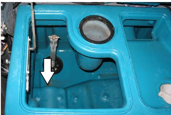
9. Schließen Sie das variable Ablassventil des Schmutzwassertanks.
