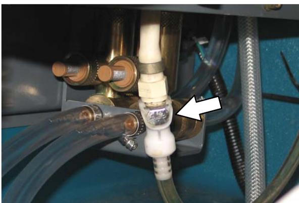
4. Entfernen Sie die perforierten Verschlüsse der neuen FaST-PAK-Packung. Nehmen Sie den Beutel nicht aus der Packung. Ziehen Sie den Schlauchanschluss an der Unterseite des Beutels heraus und entfernen Sie den Schlauchverschluss.
