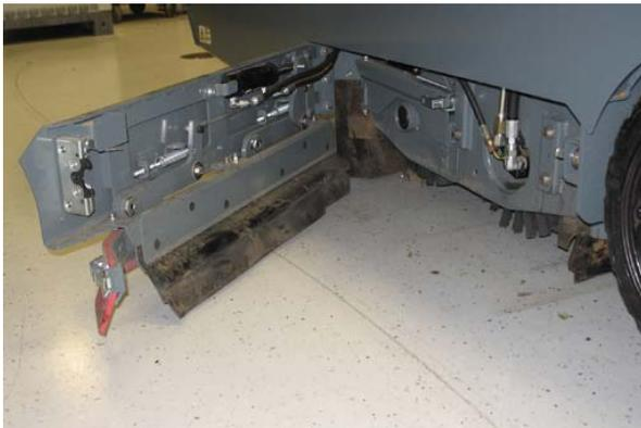
3. Öffnen Sie die inneren Bürstenklappen.
