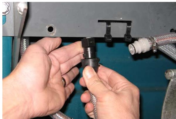
9. Blasen Sie Druckluft (weniger als 344 kPa) in den Auslassschlauch des *ec-H2O*-Systems. Blasen Sie solange weiter Druckluft in den Auslassschlauch, bis kein Wasser mehr aus dem Ablassschlauch fließt.
