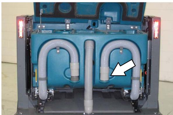
3. Öffnen Sie das variable Ablassventil des Frischwassertanks.
