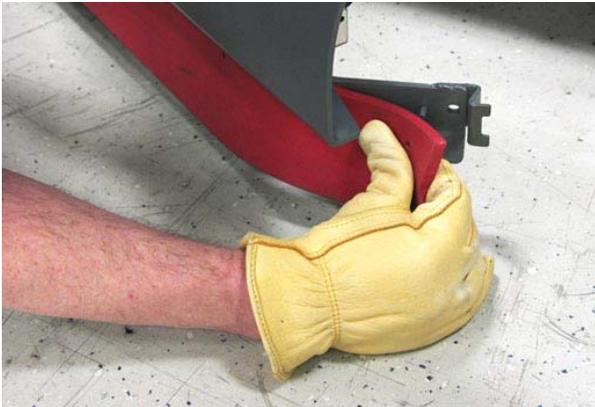
7. Befestigen Sie die Bandhalterung des Seiten-Wischgummis wieder an der Seiten-Wischgummi-Einheit.
