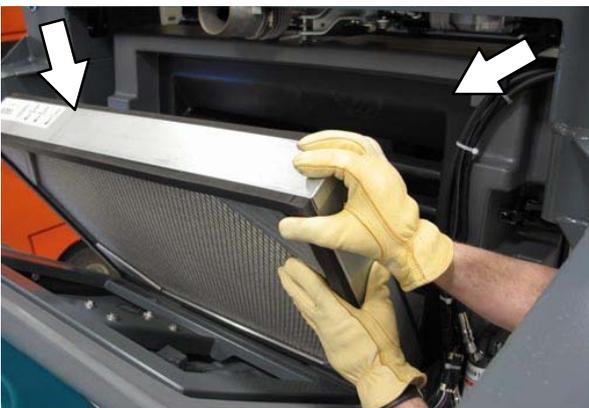
7. Reinigen bzw. entsorgen Sie den Staubfilter. Sehen Sie den Abschnitt REINIGEN DES SCHMUTZBEHÄLTER-STAUFILTERS in dieser Anleitung.
