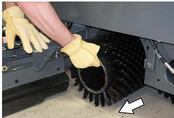
6. Bringen Sie die neuen oder gewendeten Bürsten an, indem Sie sie an den Enden abwärts drücken, während Sie sie auf die Antriebsmotor-Naben schieben.
