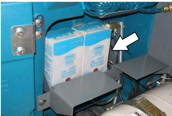
*HINWEIS:* Verwenden Sie das FaST-System oder das ec-H2O-System nicht, wenn sich herkömmliche Reinigungsmittel im Frischwassertank befinden. Lassen Sie den Frischwassertank ab, spülen Sie ihn aus und füllen Sie ihn erneut mit klarem, kaltem Wasser, bevor Sie das FaST-System oder das ec-H2O-System einschalten. Herkömmliche Reinigungsmittel können zum Ausfall des FaST-Systems oder des ec-H2O-Systems führen.
