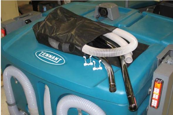
2. Befestigen Sie den Stabschlauch an den Saugschlauch.
