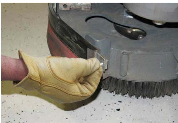
4. Ziehen Sie das Wischgummi aus der Seitenbürsten-Einheit.
