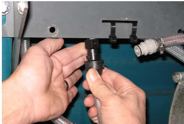
4. Führen Sie den Auslassschlauch des *ec-H2O*-Systems in einen leeren Eimer.
