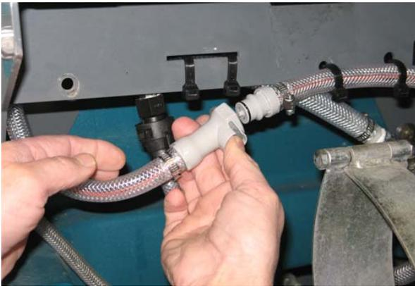
4. Ziehen Sie den Ablassschlauch zwischen der ec-H2O-Einheit und dem Fahrerraum heraus, entfernen Sie den Verschluss des Schlauchs und führen Sie das Ende des Schlauchs in einen leeren Behälter. Legen Sie den Verschluss zur Seite.
