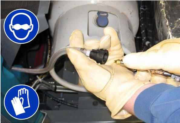
10. Bringen Sie den Verschluss wieder am Ablassschlauch an und bringen Sie den Schlauch wieder zwischen dem *ec-H2O*-Modul und dem Fahrerraum an.
