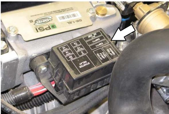
**HINWEIS:** Ersetzen Sie eine Sicherung immer durch eine Sicherung desselben Nennstroms.
