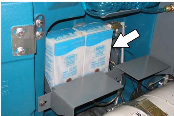
Wenn die Maschine im optionalen ES-Betrieb (Verlängerter Schrubbbetrieb) betrieben wird, wird das im Schmutzwassertank gesammelte Schmutzwasser gefiltert und durch das ES-System zur Wiederverwendung in den Frischwassertank recirkuliert. Das Reinigungsmittel wird dann in das rückgeleitete Frischwasser injiziert, wodurch die Reinigungsleistung des Frischwassers aufgefrischt wird.
