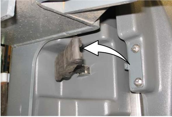
5. Öffnen Sie die Filterabdeckung und lehnen Sie diese gegen die Maschine.
