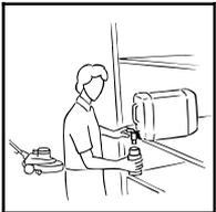
2. Entfernen Sie zunächst losen Schmutz. Überprüfen Sie den technischen Zustand der Maschine, geben Sie das Kristallisationsprodukt in die Sprayflasche und montieren Sie den Führungsteller und den Stahlwollepad an der Einscheibenmaschine. Der Boden muss für die weiteren Arbeiten vollständig trocken sein. Stellen Sie das Warnschild auf.
