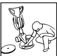
6. Reinigen Sie die Maschine und das Kabel mit einem feuchten Tuch. Wickeln Sie das Kabel lose auf. Reinigen/ waschen Sie den Pad.
