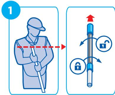
Passen Sie den Mopgriff an eine bequeme Höhe an. Lösen Sie den Handgriff durch Vierteldrehung nach links und ziehen Sie den Griff in die gewünschte Position. Verriegeln Sie den Handgriff in dieser Position durch eine halbe Umdrehung nach rechts.
