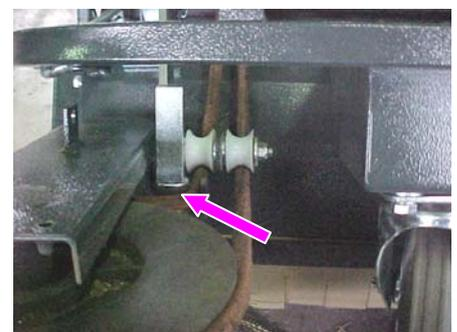
3. Die Einstellung der abgesenkten Seitenbürste prüfen: Die Schraube muss **30-31 mm.** vorstehen, damit die Bürste die richtige Schrägstellung zum Boden aufweist.
