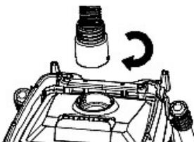
Abb. 6: Anschließen des Saugschlauchs
