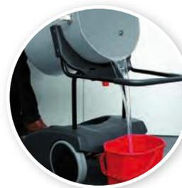
Mit Schnellentriegelungs-system zum Kippen des Behälters
