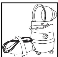
6. Wischen Sie alle Flächen und Kabel mit einem frischen feuchten Tuch. Wickeln Sie das Kabel lose auf und lassen Sie den Nasssauger zum Trocknen offen.
