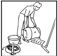
1. Leeren Sie den Tank. Spülen Sie den Tank, den Schwimmer und das Zubehör mit klarem Wasser und entfernen Sie Verschmutzungen mit einem feuchten Tuch.
