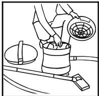
3. Saugen Sie einen Teil der Lösung auf und entsorgen Sie diese. Entfernen Sie den Schlauch, die Staubdüse, die Sauglippen und den Schwimmer und geben Sie alle Zubehörteile für 5–15 Minuten in die Desinfektionslösung.
