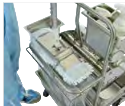
6 Mopp mit MopDrop berührungslos abwerfen. Schritt 2 – 6 wiederholen.
