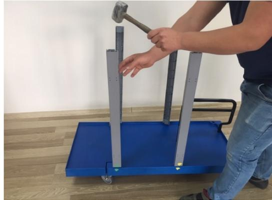
5 - Montieren Sie die Streben an den Gestell.Und leicht mit dem Hammer klopfen.
