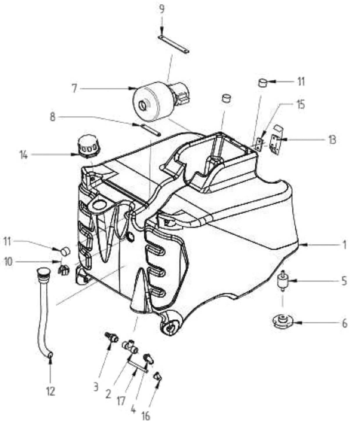
Abb. 1: Frischwassertank / Solution tank
