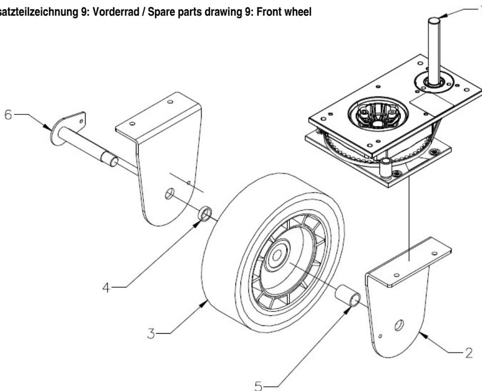
Abb. 5: Stangengestänge & Vorderrad / Rod linkage & Front wheel
