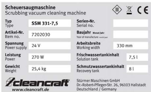
Abb. 2: Typenschild SSM 331-7,5
