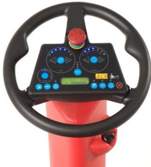
Chemiedosierung wird auf dem Bedienpanel eingestellt
