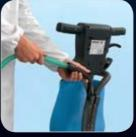
Regelmäßige Reinigung des Saugfußschlauchs für einen effizienten Saugbetrieb
