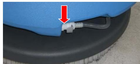
6. Die Sauberkeit der gesamten Wasseranlage, insbesondere des **Verteilerrohrs** aus Kupfer in der Mitte der Bürste prüfen
