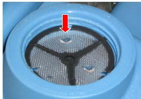
2. Die Funktionstüchtigkeit und Unversehrtheit der **Schutzdichtung** für den Verschluss des Frischwassertanks und die Funktionstüchtigkeit des **Entlüftungstifts** prüfen
