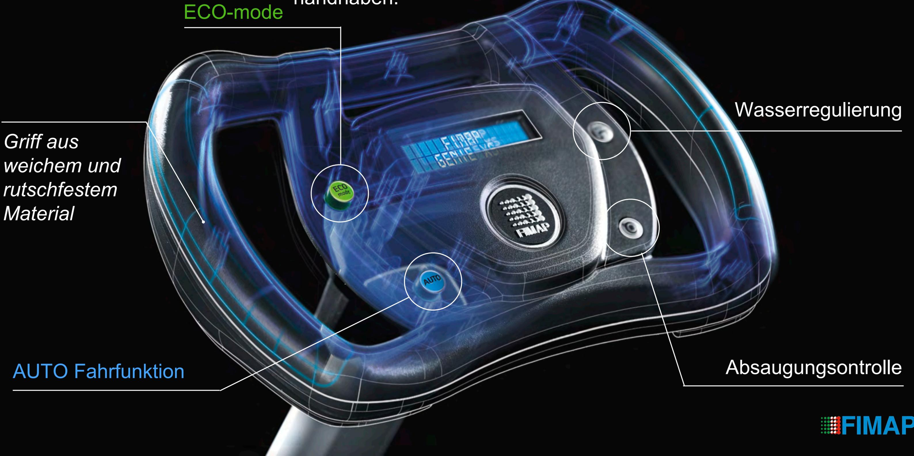
Mit der automatischen Fahrfunktion sind die Reinigungseinstellungen bereits voreingestellt. Für die Inbetriebnahme genügt ein einfacher Druck auf die AUTO-Taste.
