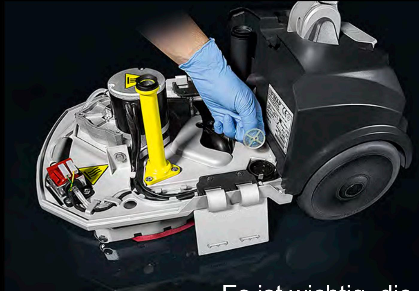
Es ist wichtig, die Reinigungslösungsfilter zu reinigen. So wird eine regelmäßige Strömung von Wasser auf die Bürste garantiert
