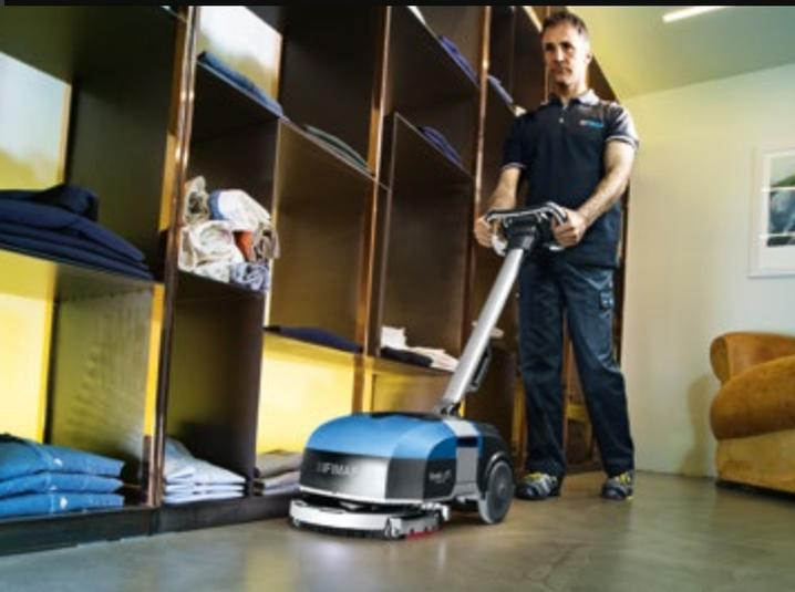
Die Bürsteneinheit verstellt sich seitlich zum Maschinengestell und ermöglicht dadurch die perfekte Reinigung entlang von Wänden. So wird die gesamte Nutzfläche des Raums hygienisch sauber.
