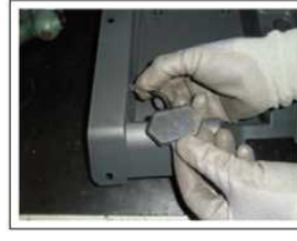
9.2.4-8 Entfernen der Bürste
