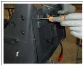
9.2.4-6 Entfernen der Bürste
