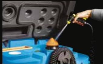
Pistole für die Reinigung der Tanks
