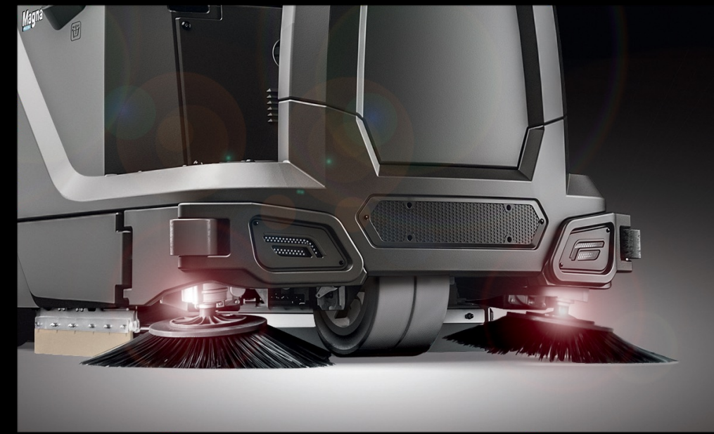
2 seitliche Kehrbürsten, die die Reinigungsleistung entlang der Wände erhöhen
