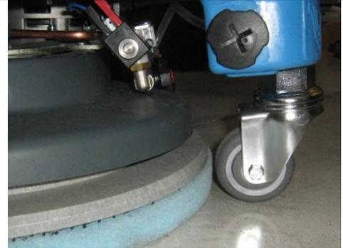
2. Die **Schraube** lösen, die das Rad am Tank festmacht.
