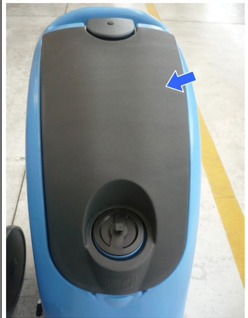
3. Den Zustand des Saugfußgummis und die korrekte Schließung der **Drehgriffe** des Saugfußanschlusses prüfen.
