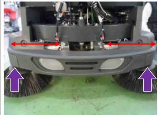
2. Für die richtige Einstellung der Auslenkung der Winden die **Mikroschalter zum Heben** und **Senken** in den Winden betätigen. Die Mikroschalter auf der Einstellungsschiene soweit gleiten lassen, bis der Zustand des Punkts 1 erreicht sind.
