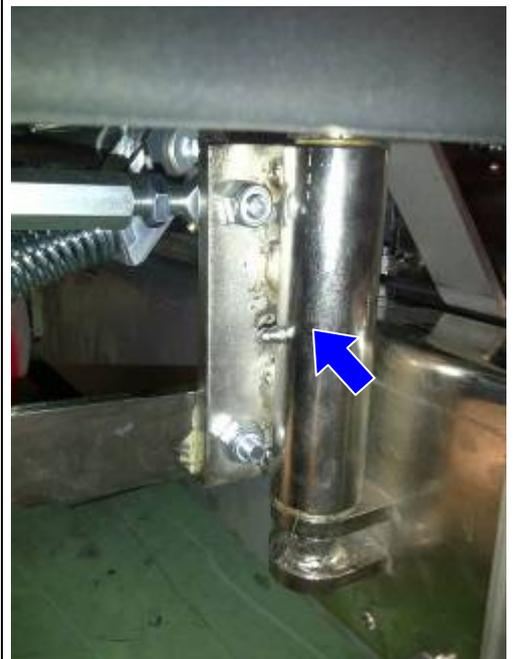
3. Die **Bolzen der Bürstenkopfwelle** einfetten (es reicht, wenn man den kleinen schwarzen Plastikverschluss entfernt).
