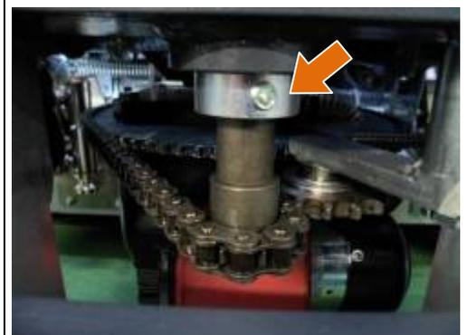
6. Die richtige Spannung der Lenkkette prüfen. Ist eine Einstellung erforderlich, an der **Einstellschraube des Kettenspanners** drehen, bis die optimale Spannung erreicht ist.
