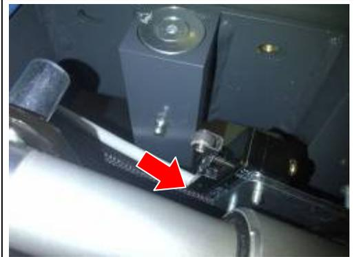
2. Prüfen, ob das Öl der Untersetzungsgetriebe in den transparenten **Ölstandsschrauben** sichtbar ist.
