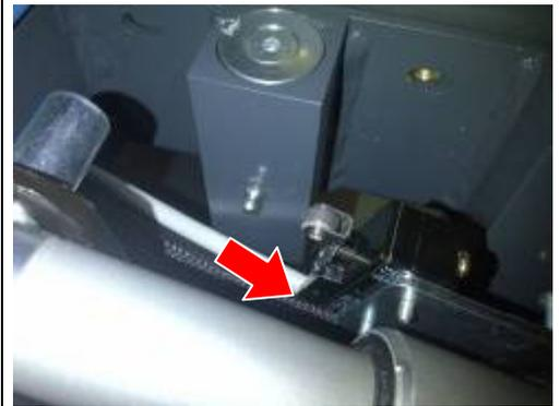
2. Die **Bolzen zum seitlichen Verstellen** des Bürstenkopfs einfetten
