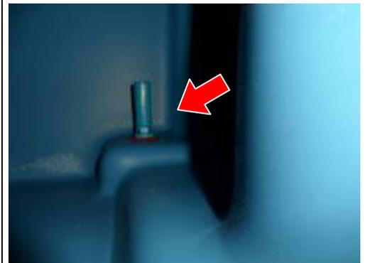
2. Die Funktionstüchtigkeit des **Schwimmers des "leeren" Schmutzwassertanks prüfen**. Bei leerem Schmutzwassertank (Schwimmer offen) und hochgestelltem Sitz muss an der Bedientafel die Kontrollleuchte aufleuchten, die das Kippen des Tanks freigibt.
