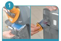
Entfernen Sie den Tank von der Maschine durch ziehen des Hebels. Entfernen Sie den Dosierbecher durch drehen nach links.
