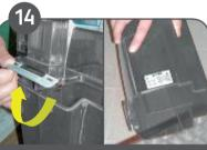
Entfernen Sie den Tank von der Maschine indem Sie den Griff ziehen. Entriegeln und entfernen Sie das Filtergehäuse. Leeren Sie den Tank und spülen Sie beide Tanks.
