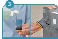
Dosieren Sie das Reinigungsprodukt in den Dosierbecher und schütten Sie diesen in den Lösungsmitteltank. Stellen Sie sicher, dass der Becher wieder exakt eingeschraubt wird.
