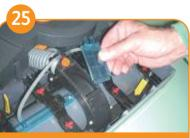
Drehen Sie den gelben Clip. Entfernen Sie die transparente Wandlerabdeckung und prüfen Sie ob die Absaugeinheit frei von Schmutz ist. Montieren Sie anschliessend die Abdeckung und verriegeln Sie diese.
