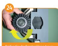
Sie die Bürste erneut einsetzen. Setzen Sie den Bürstenhalter wieder ein und drehen Sie diesen im Uhrzeigersinn bis die Riegel einrasten.
