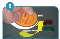
Stellen Sie den Bürstendruck ein indem Sie den Knopf langsam gegen den Uhrzeigersinn drehen bis das rote Licht erlischt. Das rote Licht zeigt an, dass der Motor überladen ist.
