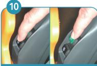
Drücken Sie erst den schwarzen Schalter für die Absaugung und anschliessend den Wasserpumpenschalter (die grüne Lampe beginnt zu leuchten).
