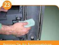
Reinigen Sie das Bürstengehäuse mit einem feuchten Tuch.
