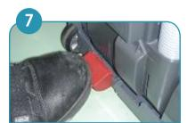
Halten Sie die Maschine fest am Griff. Bringen Sie sie durch betätigen des Fußpedals in die Arbeitsposition.
