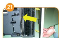
Prüfen Sie den Zustand der Lamellen bevor Sie diese installieren. Ersetzen Sie die Lamellen und beachten Sie die Seitenbezeichnungen an der Oberseite der Lamellen
