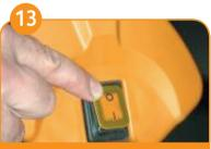
Schalten Sie die Maschine aus und verriegeln Sie diese in der vertikalen Parkposition. Trennen Sie vor jeder Wartung den Stecker!
