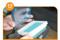
Hängen Sie die transparente Filterabdeckung aus und entfernen Sie den Filter. Waschen Sie den Filter unter laufendem Wasser. Wringen Sie den Filter aus um das Wasser zu entfernen.
