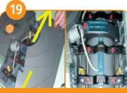
Entfernen Sie die Abdeckung des Bürstengehäuses durch verschieber der Riegel. Drehen Sie die gelben Clips bis diese sich lösen und die Lamellen freigeben
