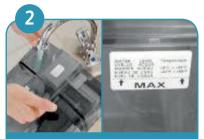
Füllen Sie den Lösungsmitteltank mit frischem Wasser bis zur Füllstandsmarkierung. Die Markierung finden Sie an der Seite des Tanks.
