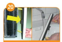
Legen Sie die Maschine auf die linke Seite und entfernen Sie die Lamellen. Waschen Sie die Lamellen unter zimmerwarmem Wasser.
