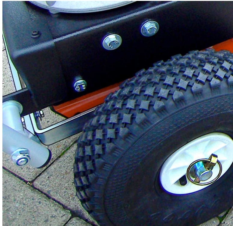
Abbildung 6: korrekte Montage Lenker / Stützwinkel
