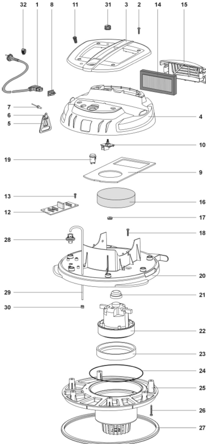
Abb. / Fig. 3: Ersatzteilzeichnung 1 / Spare parts drawing 1
