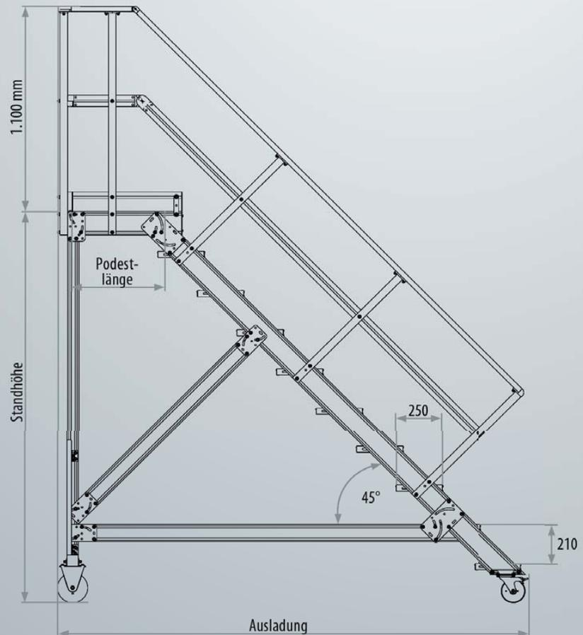
**Stufenbreite 600 mm**
