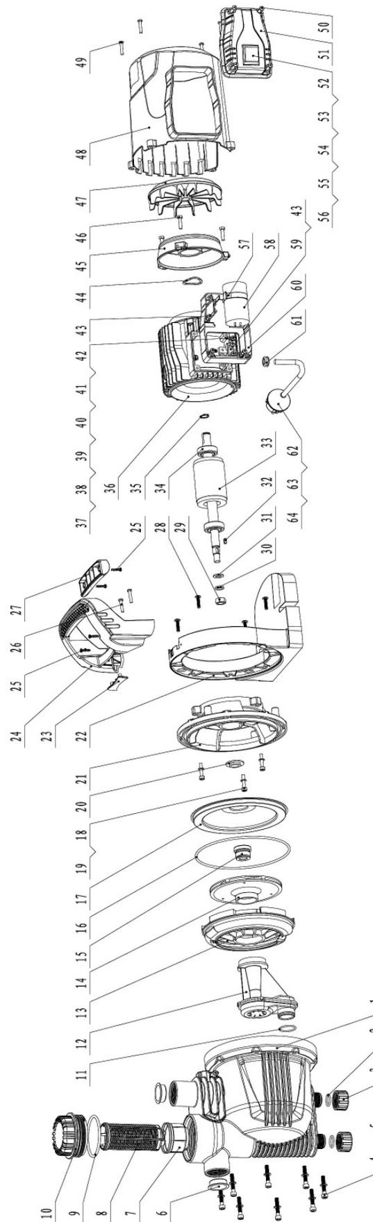
Abb. / Fig. 2: Ersatzteilzeichnung GP 1105 P / Spare parts drawing GP 1105 P
