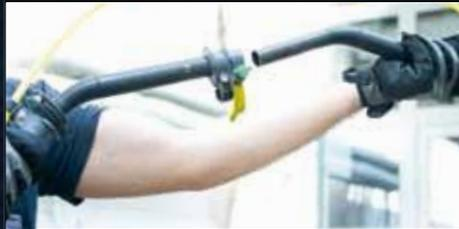
Lösen Sie die Klemme am obersten Element der Stange. Setzen Sie den Winkeladapter auf die Stange auf und sichern Sie diesen durch Schließen der Klemme. Falls nötig, ziehen Sie die Klemme fest.
